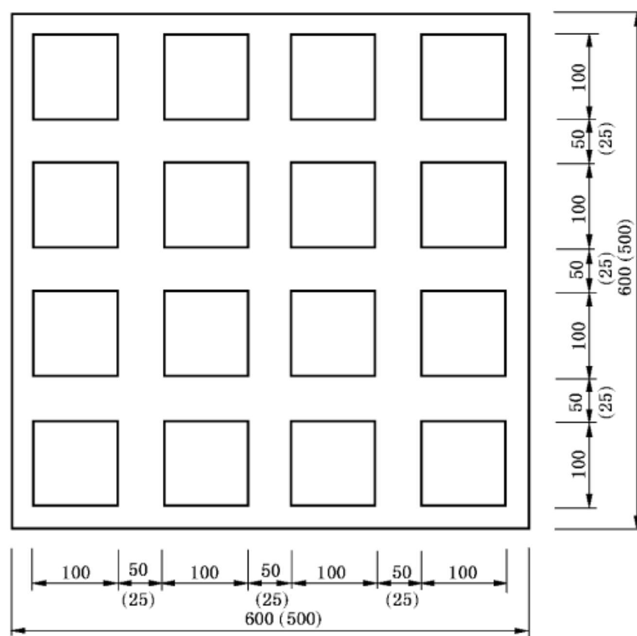
图 14 均布荷载聚氨酯块分布示意图
