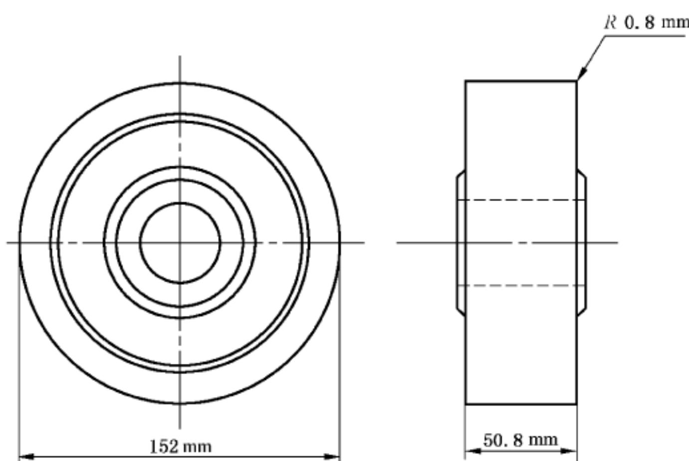
图 11 B 滚动轮尺寸示意图
