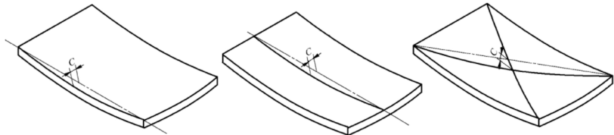
图 6 表面平面度测量示意图
