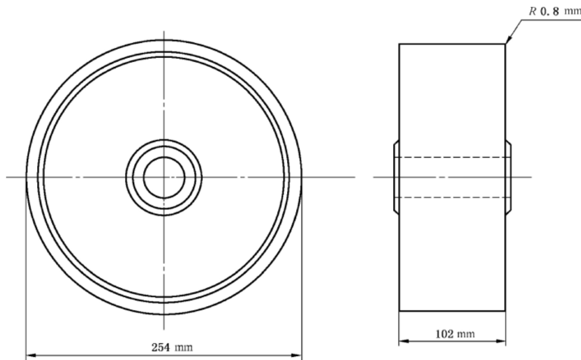
图 12 C 滚动轮尺寸示意图
