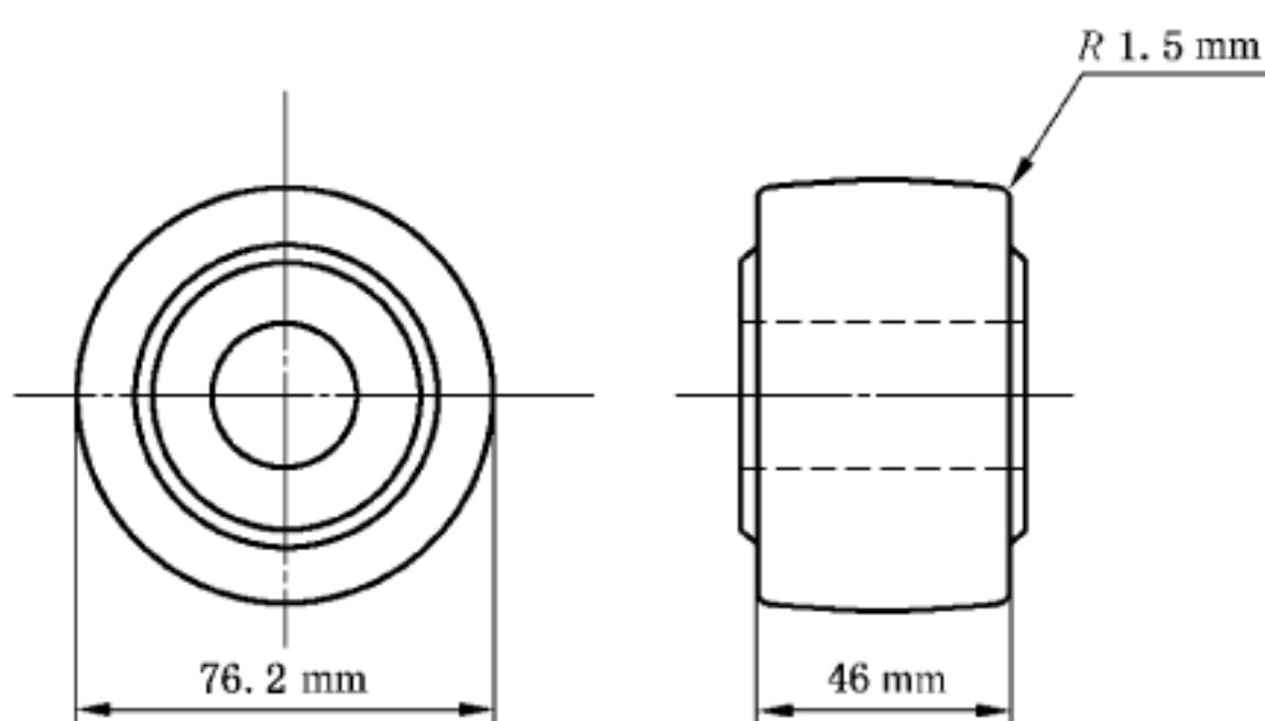
图 10 A 滚动轮尺寸示意图
