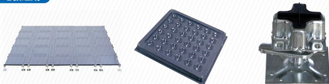
网络地板采用优质冷轧钢板, 经拉伸后点焊成形, 外表经磷化后进行喷塑处理, 内腔填充发泡水泥, 四角带有角锁孔。
